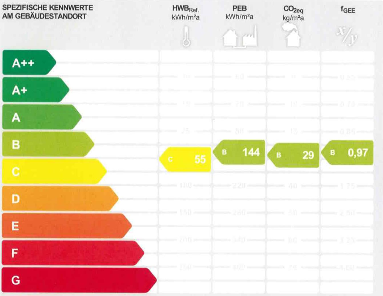
**HWB<sub>Ref.</sub>:** Der **Referenz-Heizwärmebedarf** ist jene Wärmemenge, die in den Räumen bereitgestellt werden muss, um diese auf einer normativ geforderten Raumtemperatur zu halten. Dabei werden etwaige Erträge aus Wärmerückgewinnung raumlufttechnischer Anlage nicht berücksichtigt.
